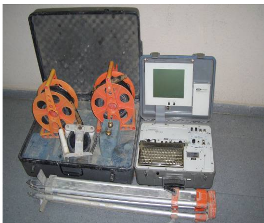
Ensayos de campo para comprobación de continuidad de cimentaciones profundas.
