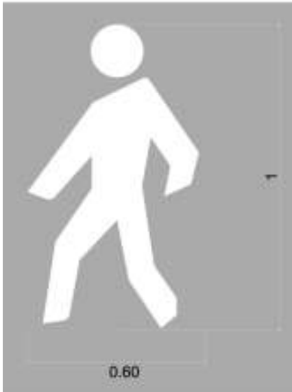
B-6.10. Peatón. Señalización horizontal sobre el pavimento que indica el espacio reservado para el uso exclusivo de peatones.
