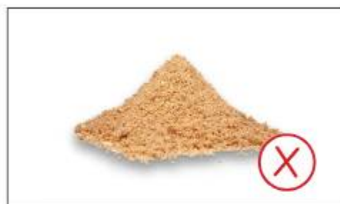
CADENA MAL AFILADA O DESGASTADA (SERRÍN MUY FINO)
