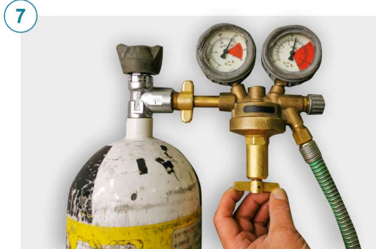
Regular la presión del aire en la salida de la etapa de baja del regulador entre 6 y 8 bares.
