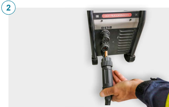
Conectar la antorcha manual con cable coaxial al equipo en el alojamiento del euroconector, roscándolo posteriormente.
