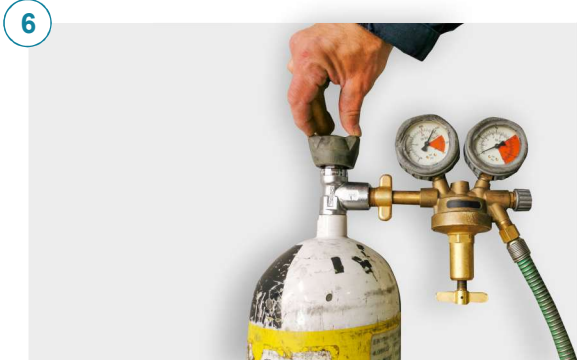
Abrir la botella comprobando que la etapa de baja del regulador se encuentra cerrada (mariposa suelta), con lo que evitaremos golpes de ariete por sobrepresión.
