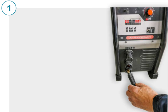
Conectar el cable de masa a la toma hembra normalizada del equipo, girando ¼ de vuelta.
