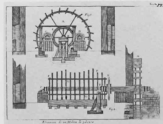
Elevación de un Molino de pólvora
