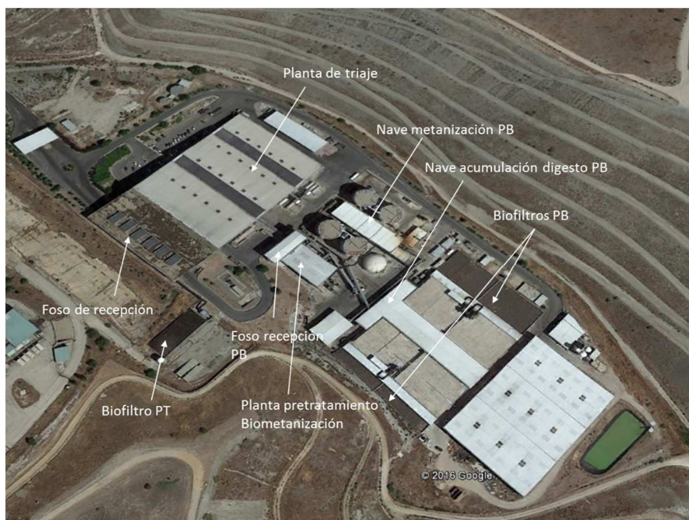
Figura 19. Localización de los focos de emisión en el Planta de Tratamiento y Planta de Biometanización La Paloma.
