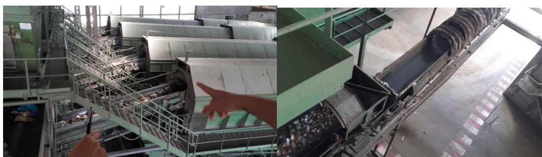
Figura 72. Trómeles y cinta en nave de triaje PCC Dehesas
