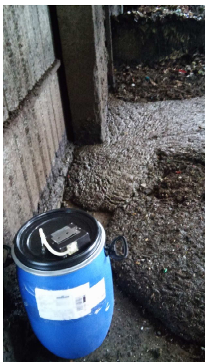
Figura 92. Toma de muestras, con el método puntual, del ambiente general de la nave de digestión de lodos en Las Dehesas.
