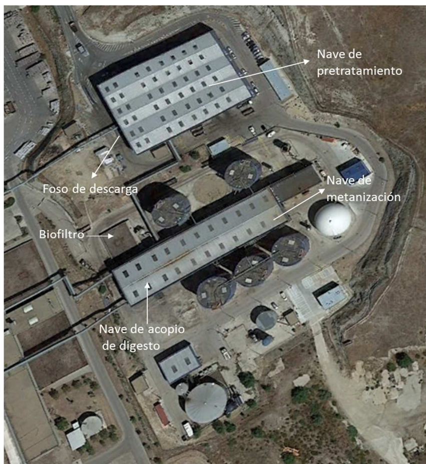
Figura 15. Esquema focos de emisión Planta Biometanización Las Dehesas.
