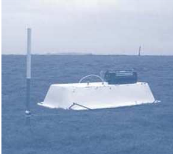
Figura 82. Instalación de campana de flujo y detector de CH 4 para medidas en campo (Environment Agency - Guidance on monitoring landfill gas surface emissions).
