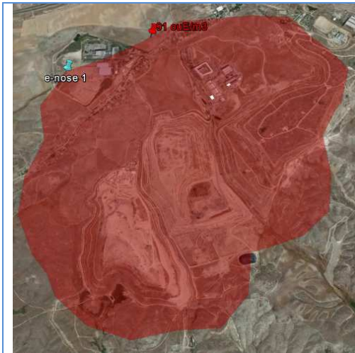
(de izq. a dcha.) Figura 89k, ZONA 5. Mapa de frecuencia de “horas de olor” del olor caracterizado como “olor acumulado RSU”, calculado mediante el método VDI/DIN 3940 e impacto según modelo Calpuff – isodora 91 \text{uo}_E/\text{m}^3 percentil C_{98,1h} . Foco: olores procedentes del Parque Tecnológico de Valdemingómez.
