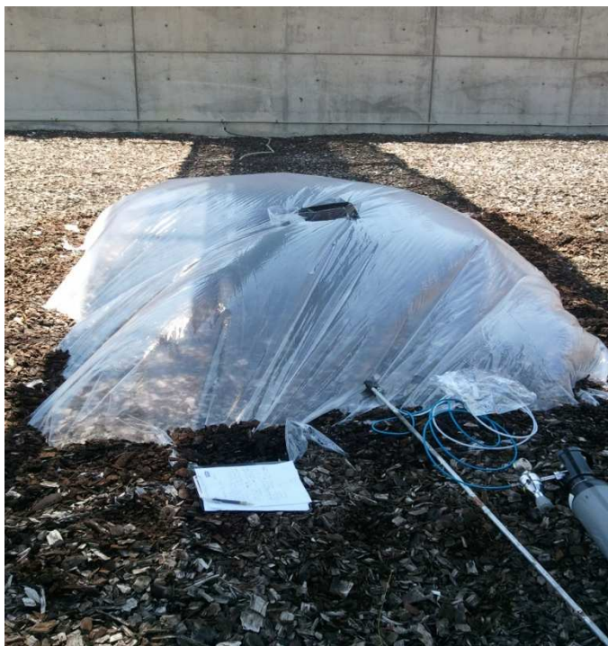
Figura 93. Toma de muestras, con el método de la sonda de dilución a la salida de uno de los módulos de Biofiltración.
