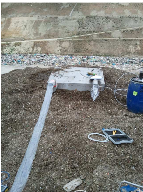
Figura 100. Toma de muestras, con el método de la caja Lindvall, sobre el frente de explotación cubierto con compost (celda 5).
