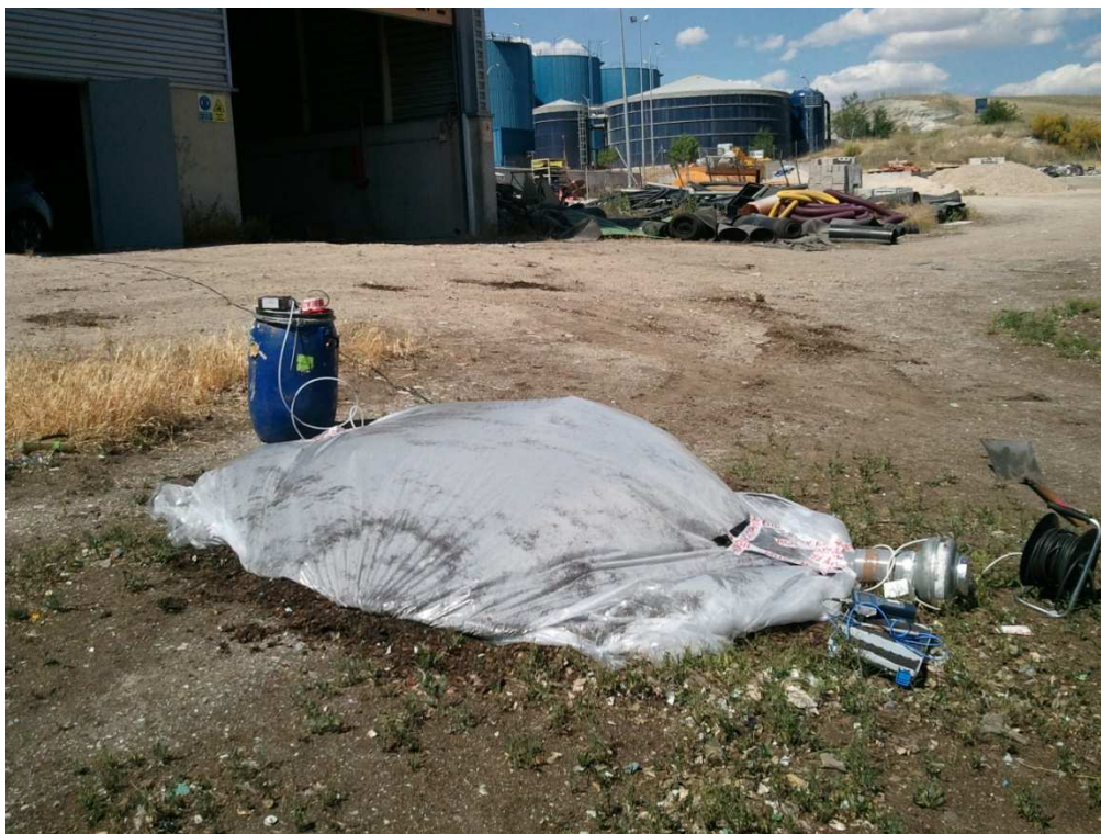
Figura 95. Toma de muestras, con el método de la caja Lindvall, sobre el acopio de compost.
