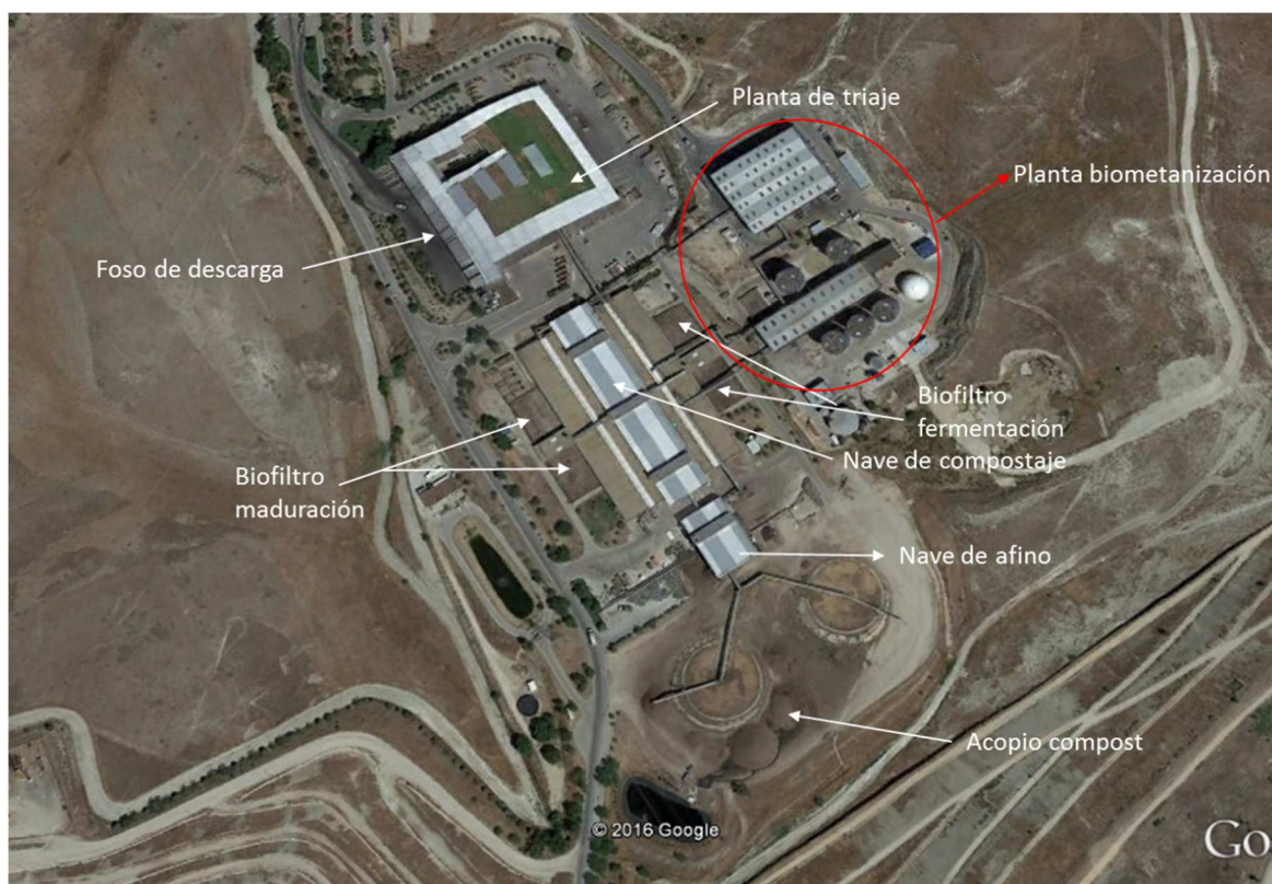
Figura 14: Esquema focos de emisión Planta clasificación y compostaje Las Dehesas.
