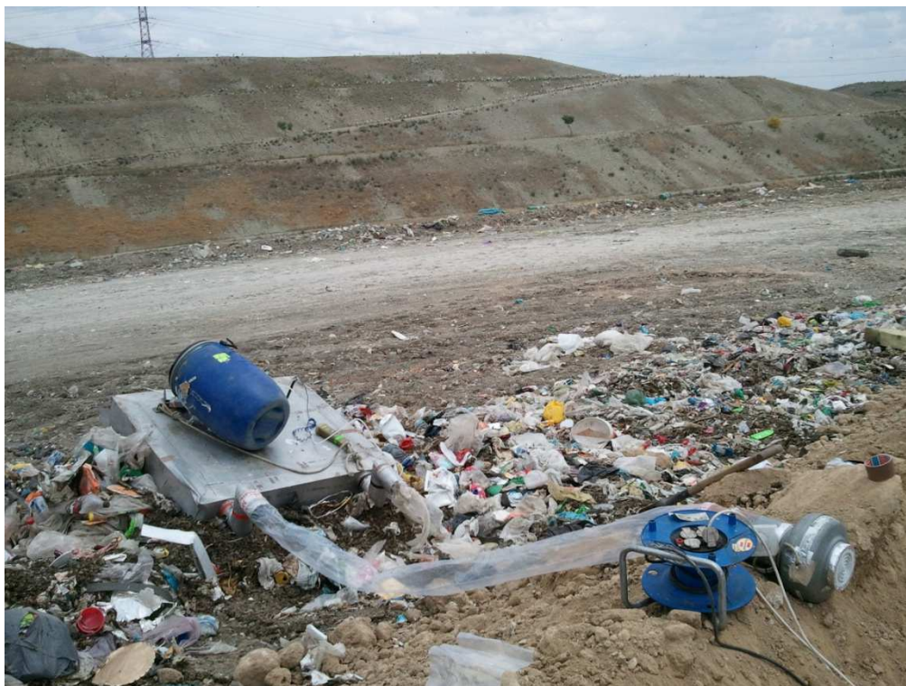
Figura 99. Detalle toma de muestras, con el método de la caja Lindvall, sobre el frente de vertido (celda 5).
