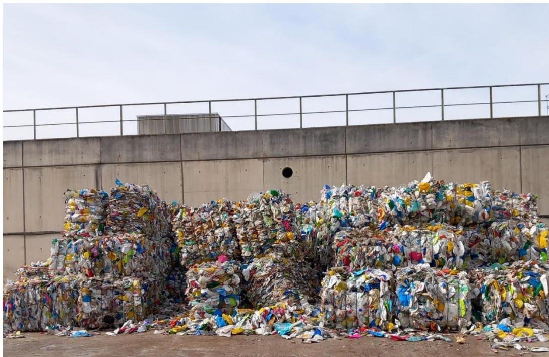
Recuperación de plástico-balas de polietileno de alta densidad (PEAD)
