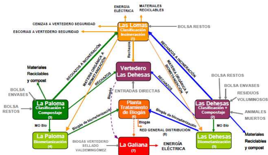
Figura 6.1 Esquema global de funcionamiento del Parque Tecnológico de Valdemingómez
