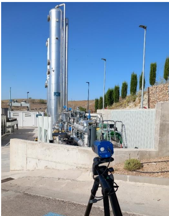
Cámara OGI para detección de emisiones fugitivas
