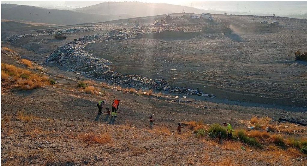
Trabajos de medición de emisiones fugitivas con trazadores por parte de la Universidad Técnica de Dinamarca (DTU) – mayo 2025
