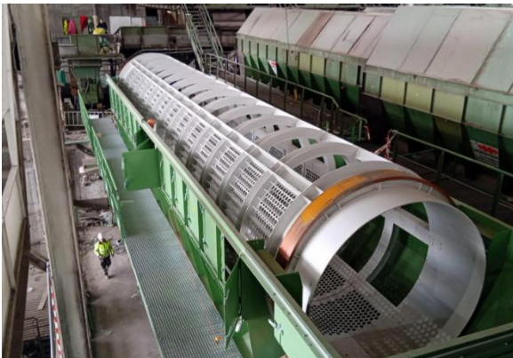
Trómel TR-1000 para monodosis (fracción 0-100 mm)
