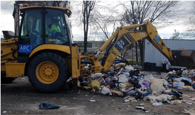
El vehículo que transporta el residuo vierte la muestra en la plataforma de descarga de la planta. Una pala cargadora homogeniza el residuo y realiza una serie de cuarteos para asegurar la correcta representatividad de la muestra.
