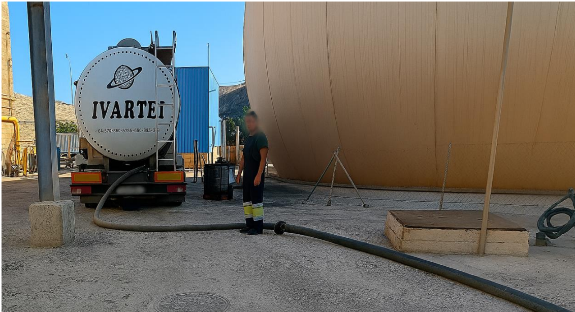
Carga de lixiviados en la planta de biometanización de Las Dehesas
