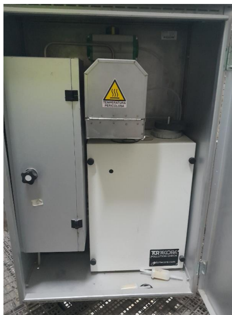
Muestreador en continuo y sonda de la línea 1 en "Las Lomas"
