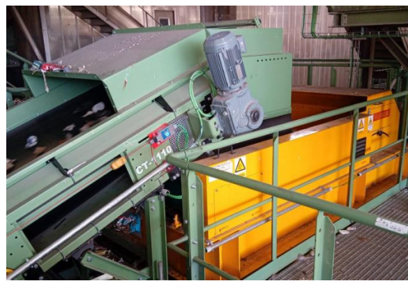
Separador inductivo SI-1000 rebose de trómel TR-1000 (fracción 60-100 mm) y cinta CT-1110
