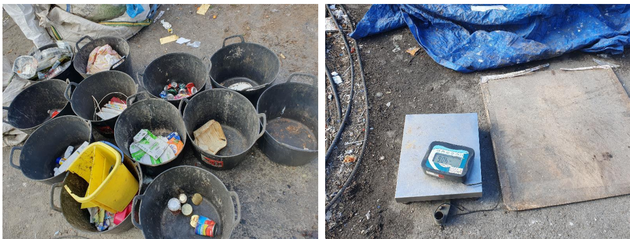
Pesada de materiales y relleno hoja de campo (trazabilidad). Finalmente, la pala cargadora se encarga de verter restos de la caracterización al foso. Análisis estadístico de resultados obtenidos.
