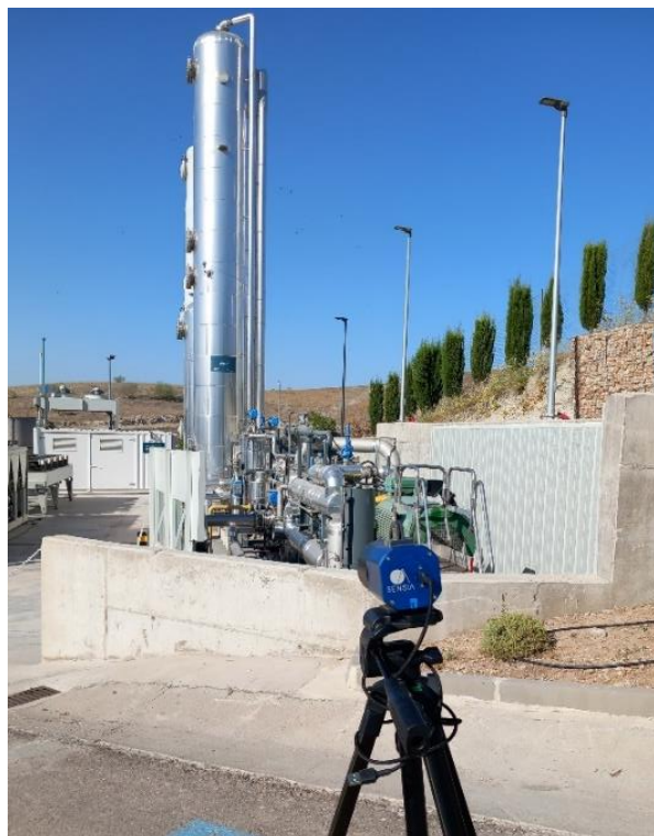
Cámara OGI para detección de emisiones fugitivas
