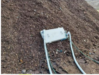
Muestreo de olores en el afino de los túneles de compostaje de "Las Dehesas"
