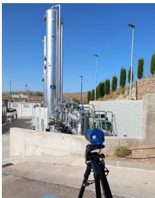
Cámara OGI para detección de emisiones fugitivas
