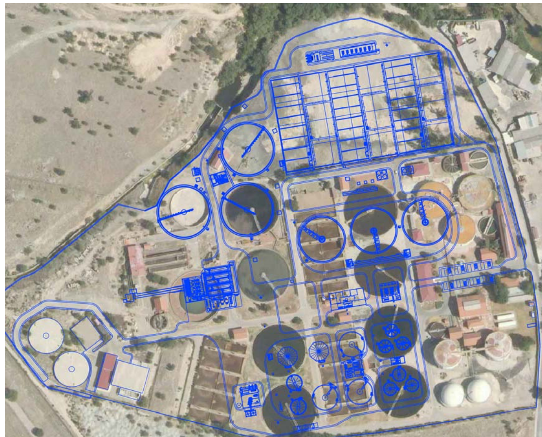
Ilustración 15. Solución elegida, proceso biológico de fangos activos con reducción de nutrientes
