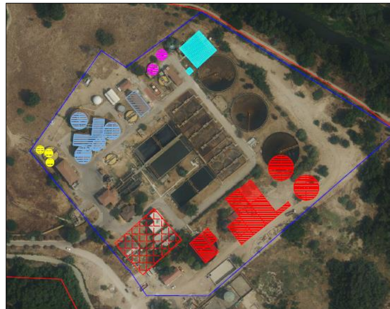
Fig. 16 – Opción 2 de implantación de línea de fangos. Fuente: Elaboración propia.
