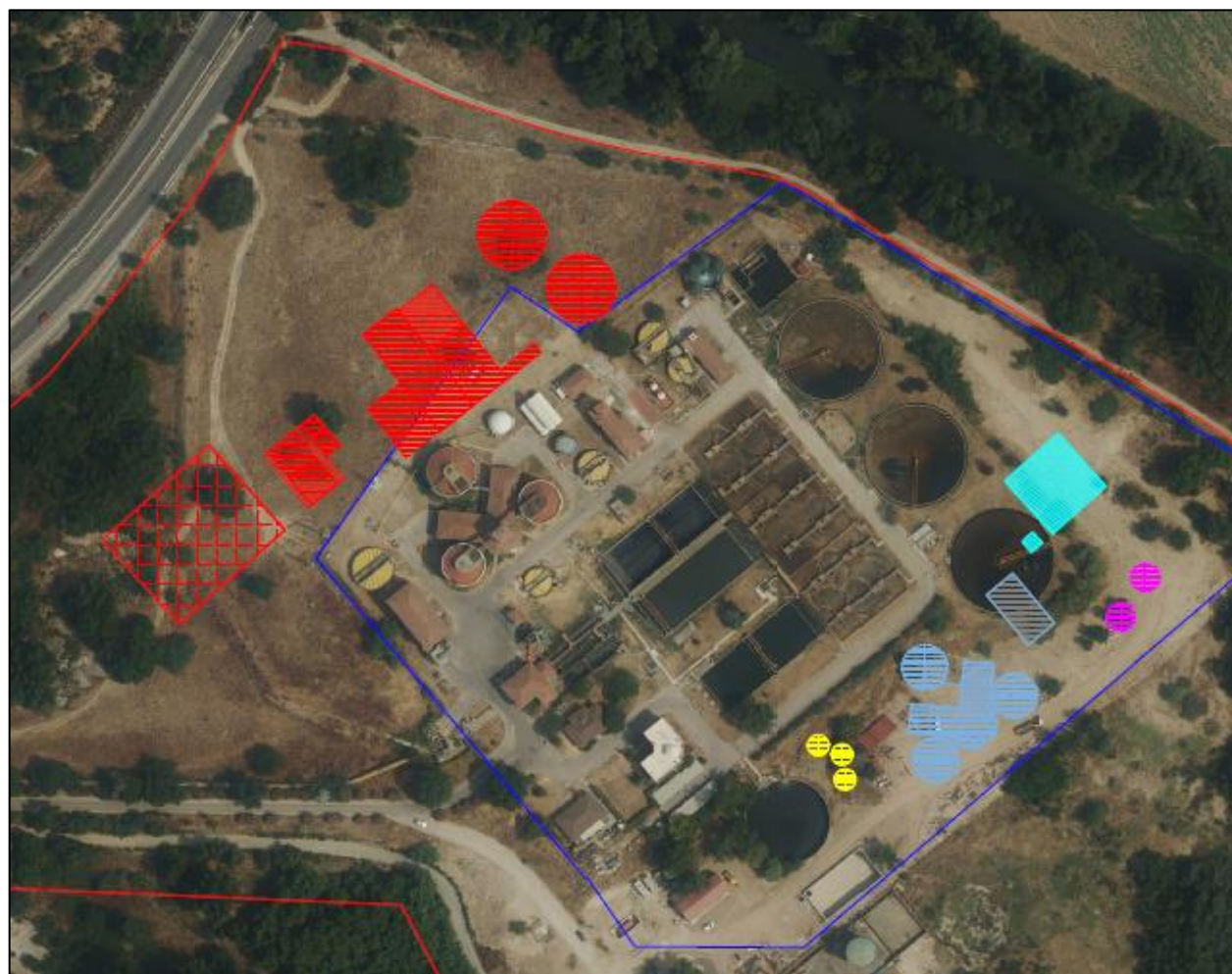
Fig. 15 –Opción 1 de implantación de línea de fangos. Fuente: Elaboración propia.
