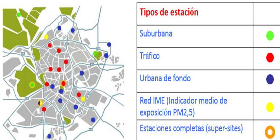
Fig 1.- Esquema de la red actual de estaciones de vigilancia de la calidad del aire.
