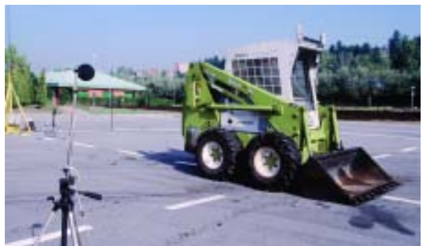
Medición de la potencia sonora de una pala en la plataforma del Centro Municipal de Acústica
