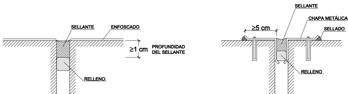
Figura 2.6 Ejemplos de juntas de dilatación
