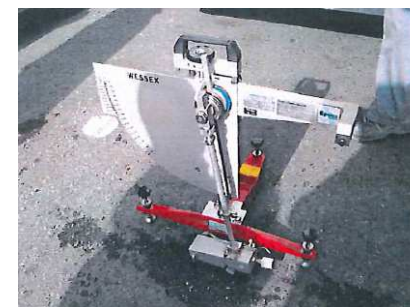
Seguimiento de la resistencia al deslizamiento UNE-ENV 12633:2003 en zona tratada con EMULSIÓN, transcurridos 5 meses
