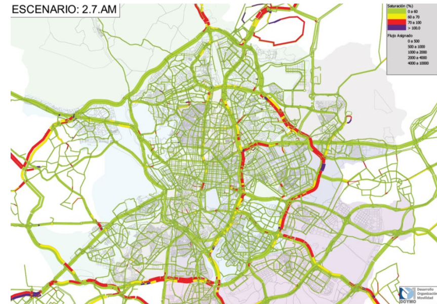
Ilustración 154. Intensidades de tráfico y nivel de saturación (Intensidad/Capacidad) en hora punta de mañana. Escenario 2030. Fuente: elaboración propia
