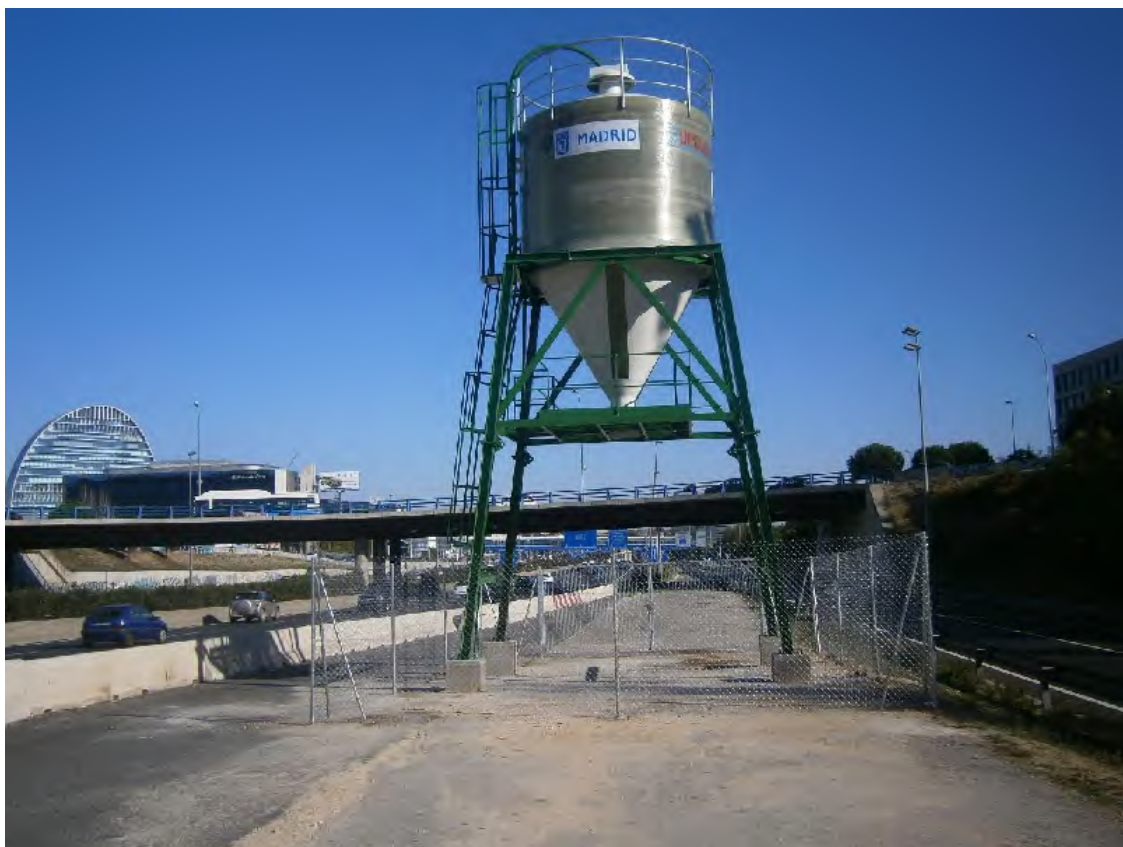
Foto. 2 Fotografía de silo de sal de 35 tm en A-1
