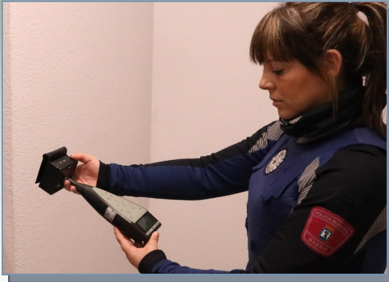
Una agente calibrando el sonómetro para realizar mediciones
