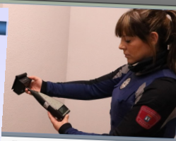
Un agente calibrando el sonómetro para realizar mediciones de ruido.
