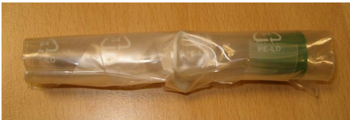
Muestras correctas; El vial estanco lleva una protección plástica adicional también estanca para, en caso de rotura, contener el insectos. En el caso de líquidos, entre ambos elementos de contención sería necesario prever la existencia de material absorbente. (Fotografía: UTCV-Madrid Salud)
