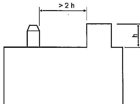
4. Si en los planos de cubierta existieran huecos, será de aplicación lo establecido en la norma UNE relativa al remate de chimenea.
