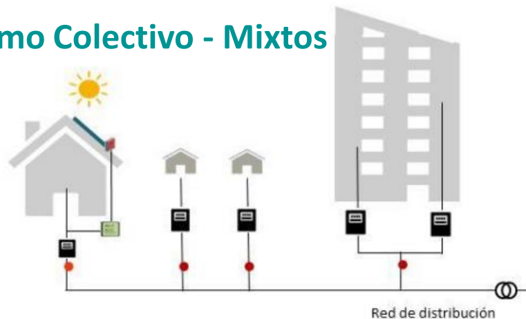
Generación en red interior de un consumidor (PG+PF) , con otros consumidores adscritos en proximidad a través de red
