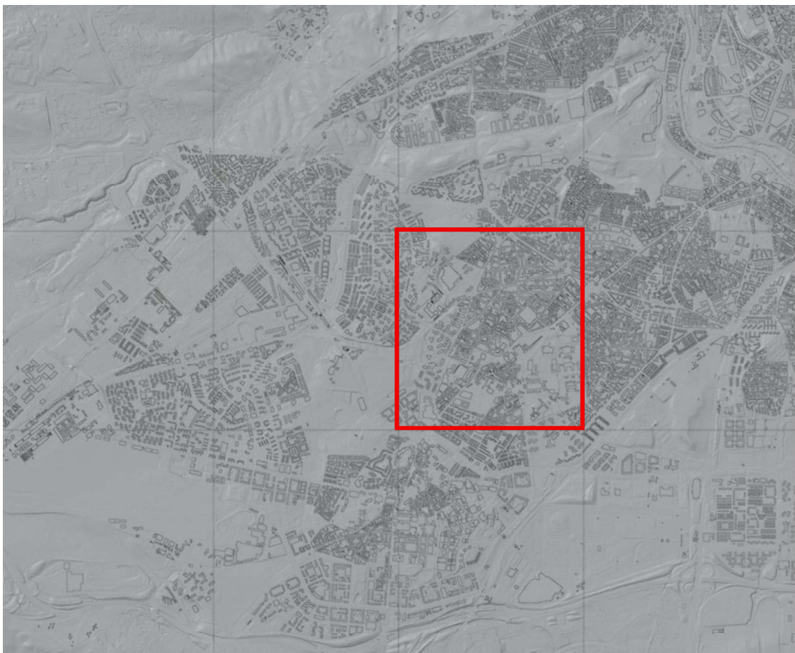
Figura 4: Visualización de la geometría reconstruida. El dominio total se ha dividido en 12 zonas por optimización computacional. El cuadrado rojo destaca la subregión mostrada en la Figura 5.
