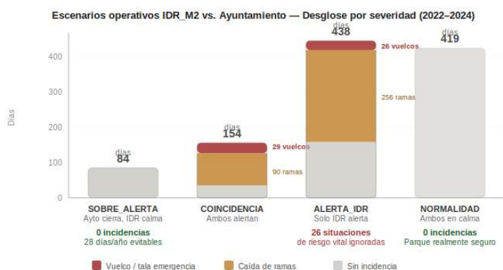
Figura 7. Distribución de los 1.096 días analizados por escenario operativo y severidad de incidencia. Los 84 días de SOBRE_ALERTA y los 419 de NORMALIDAD no registran ninguna incidencia. Los 438 días de ALERTA_IDR contienen 26 vuelcos y 256 caídas de ramas que el sistema actual dejó pasar.
