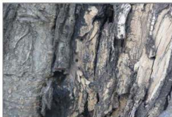
4.b Orificios de insectos perforadores de la madera
