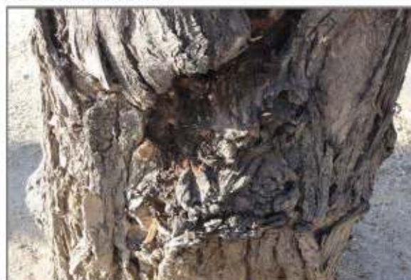
4.b Degradación de la madera en la base
