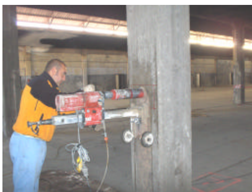
Extracción de una probeta testigo en un pilar.
