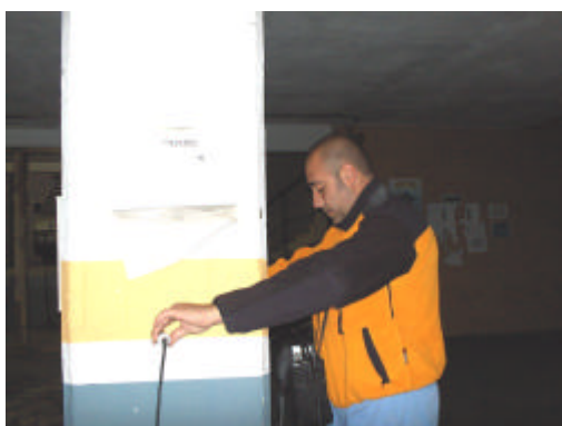
Reconocimiento ultrasónico de pilares del edificio
