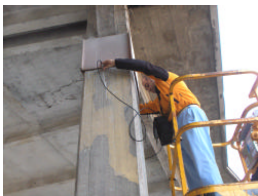
Reconocimiento ultrasónico de pilares del edificio
