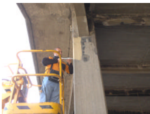
Reconocimiento esclerométrico de pilares del edificio
