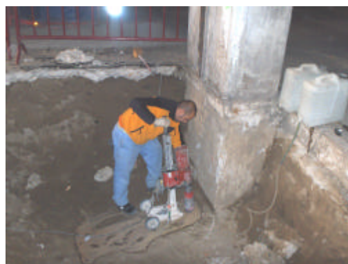
Extracción de una probeta testigo en una zapata.
