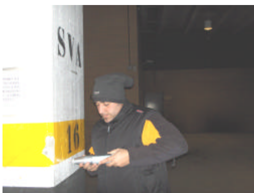
Reconocimiento esclerométrico de pilares del edificio
