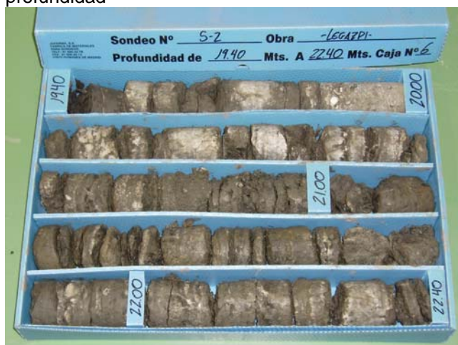
Sondeo S-2, C-6, de 19,40 m a 22,40 m de profundidad
