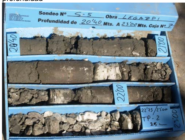
Sondeo S-5, C-7, de 20,40 m a 23,00 m de profundidad
