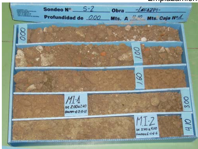
Sondeo S-2, C-1, de 0,00 m a 4,10 m de profundidad
