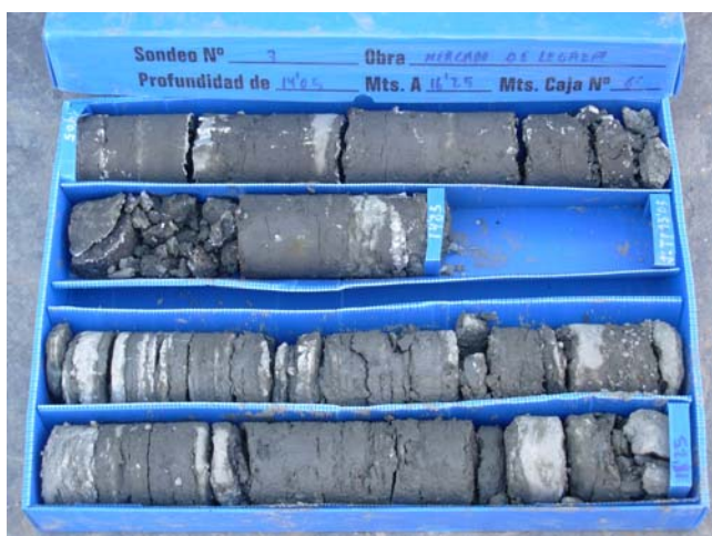
Sondeo S-7, C-6, de 14,05 m a 16,25 m de profundidad
