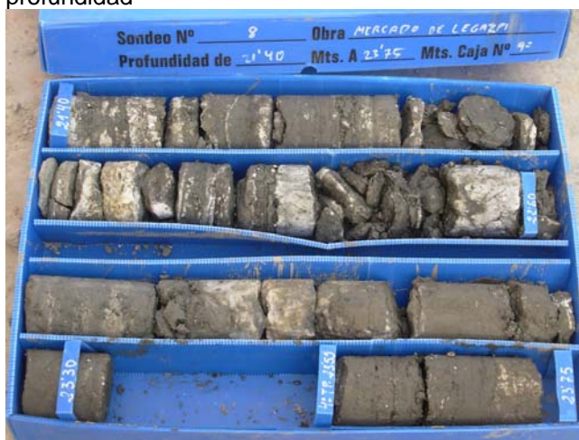
Sondeo S-8, C-9, de 21,40 m a 23,75 m de profundidad
