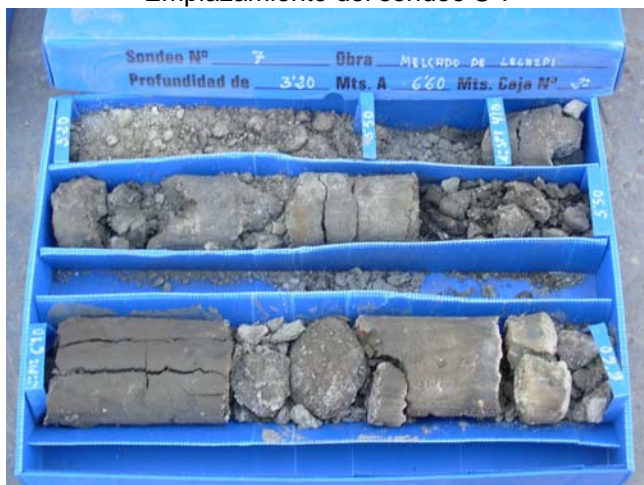
Sondeo S-7, C-2, de 3,20 m a 6,60 m de profundidad
