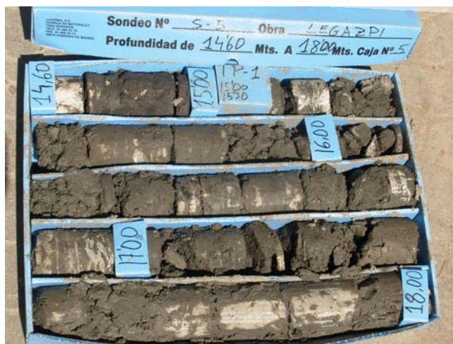
Sondeo S-5, C-5, de 14,60 m a 18,00 m de profundidad
