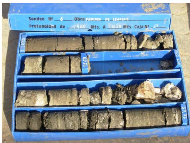
Sondeo S-8, C-6, de 14,50 m a 16,65 m de profundidad
