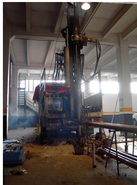
Sondeo S-5 efectuado con la sonda Cibeles C-60 de la empresa Intemac.
