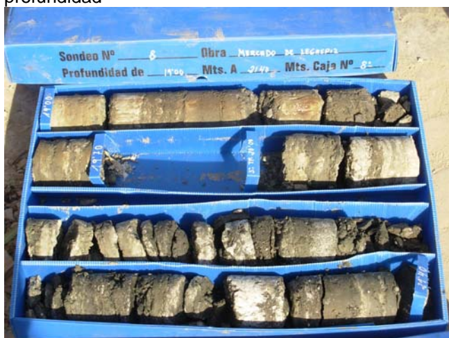
Sondeo S-8, C-8, de 19,00 m a 21,40 m de profundidad
