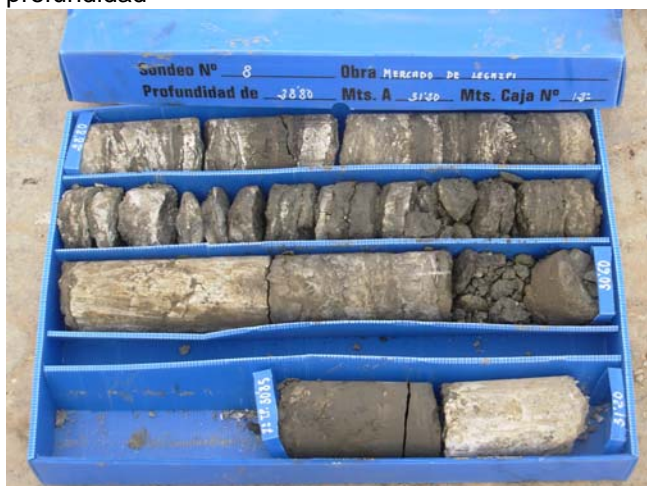
Sondeo S-8, C-12, de 28,80 m a 31,20 m de profundidad
