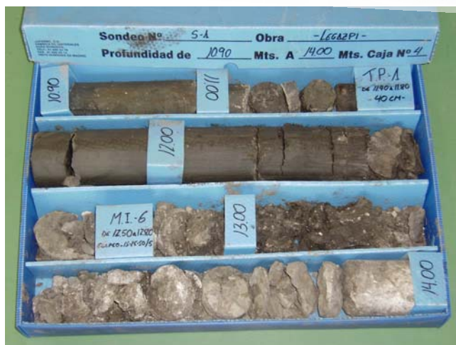
Sondeo S-1, C-4, de 10,90 m a 14,00 m de profundidad
