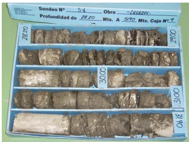
Sondeo S-1, C-9, de 28,20 m a 31,90 m de profundidad
