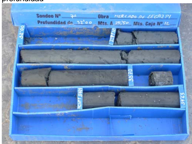
Sondeo S-7, C-12, de 32,00 m a 35,50 m de profundidad
