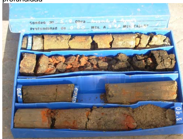
Sondeo S-8, C-1, de 0,00 m a 3,90 m de profundidad
