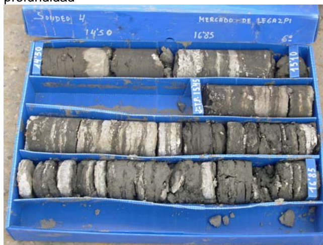
Sondeo S-4, C-6, de 14,50 m a 16,85 m de profundidad
