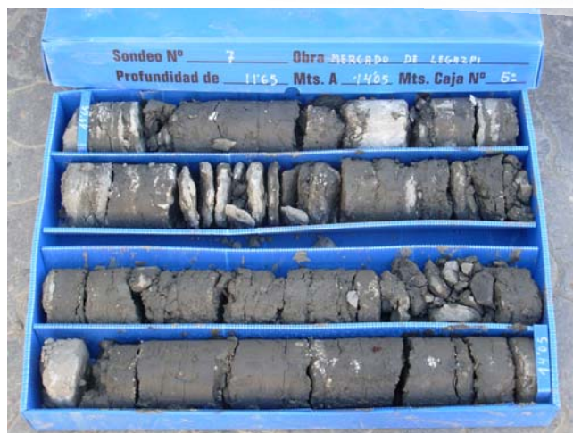
Sondeo S-7, C-5, de 11,65 m a 14,05 m de profundidad
