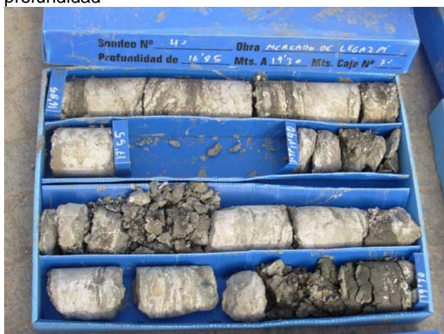
Sondeo S-4, C-7, de 16,85 m a 19,30 m de profundidad
