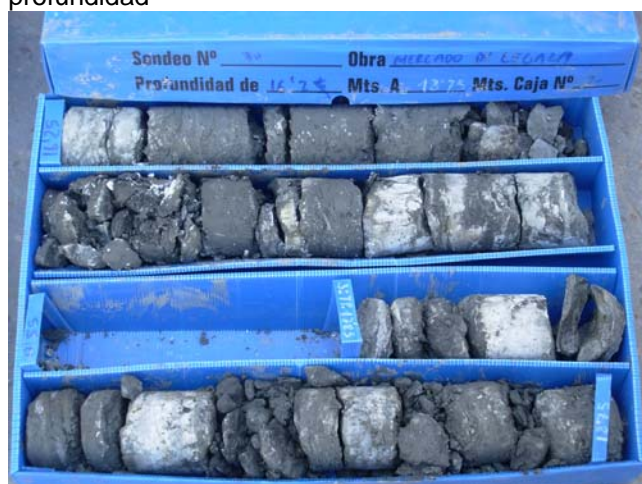
Sondeo S-7, C-7, de 16,25 m a 18,75 m de profundidad
