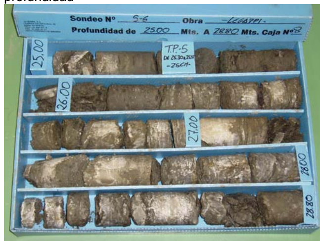
Sondeo S-6, C-8, de 25,00 m a 28,80 m de profundidad
