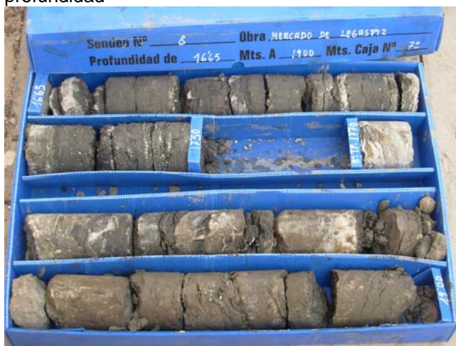
Sondeo S-8, C-7, de 16,65 m a 19,00 m de profundidad
