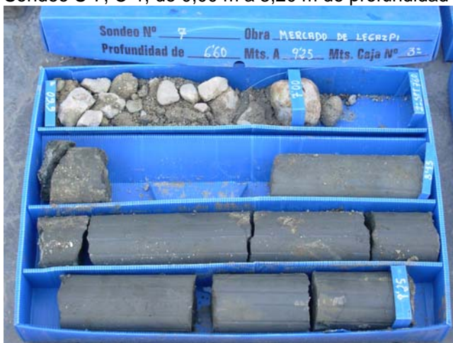
Sondeo S-7, C-3, de 6,60 m a 9,25 m de profundidad
