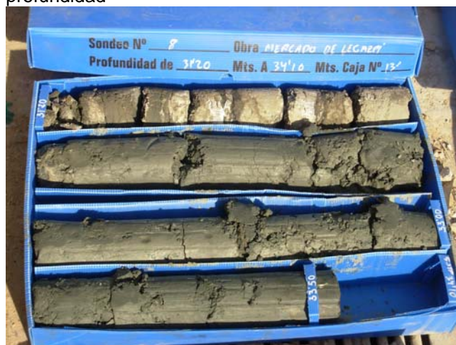
Sondeo S-8, C-13, de 31,20 m a 34,10 m de profundidad
