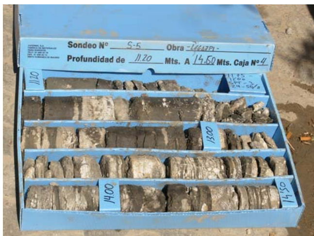
Sondeo S-5, C-4, de 11,20 m a 14,50 m de profundidad
