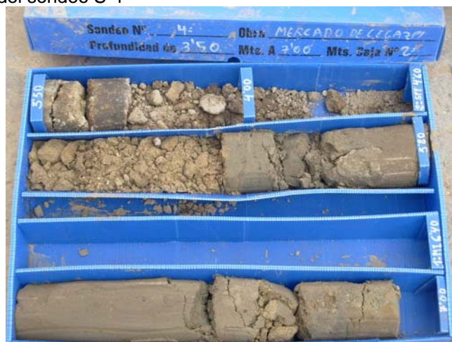
Sondeo S-4, C-2, de 3,50 m a 7,00 m de profundidad
