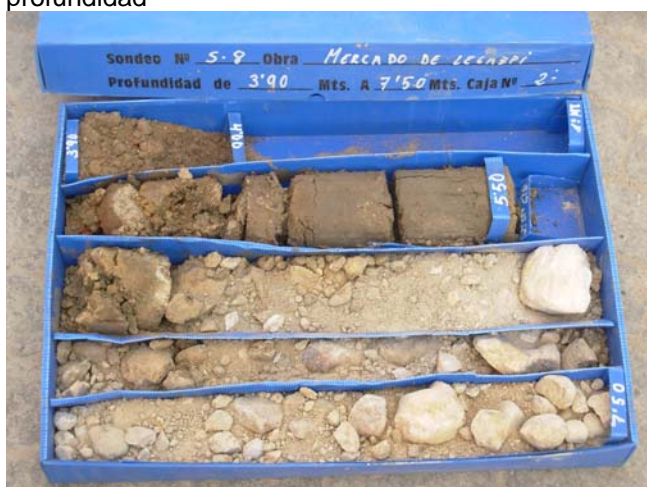
Sondeo S-8, C-2, de 3,90 m a 7,50 m de profundidad
