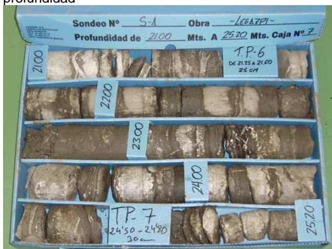
Sondeo S-1, C-7, de 21,00 m a 25,20 m de profundidad
