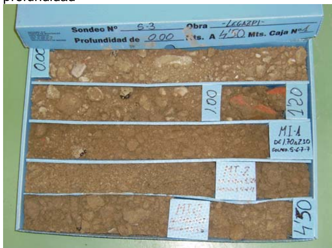
Sondeo S-3, C-1, de 0,00 m a 4,50 m de profundidad
