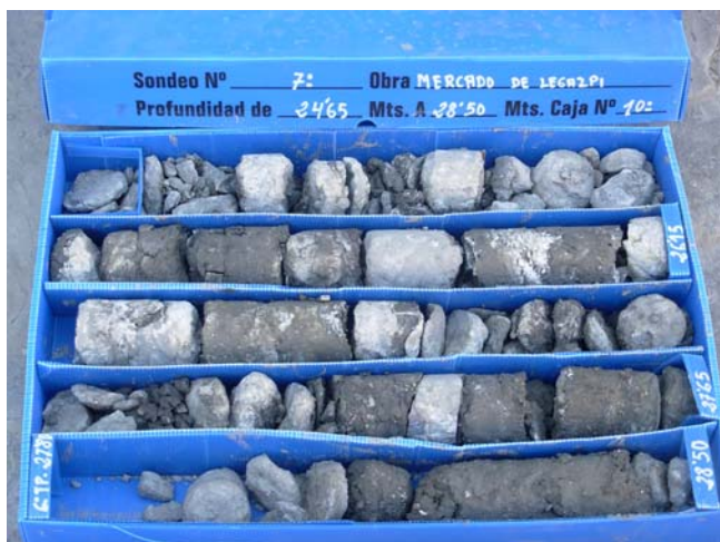
Sondeo S-7, C-10, de 24,65 m a 28,50 m de profundidad
