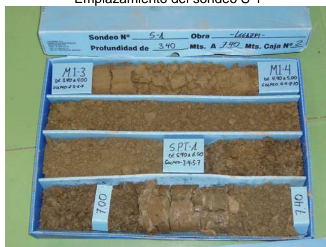
Sondeo S-1, C-2, de 3,40 m a 7,40 m de profundidad
