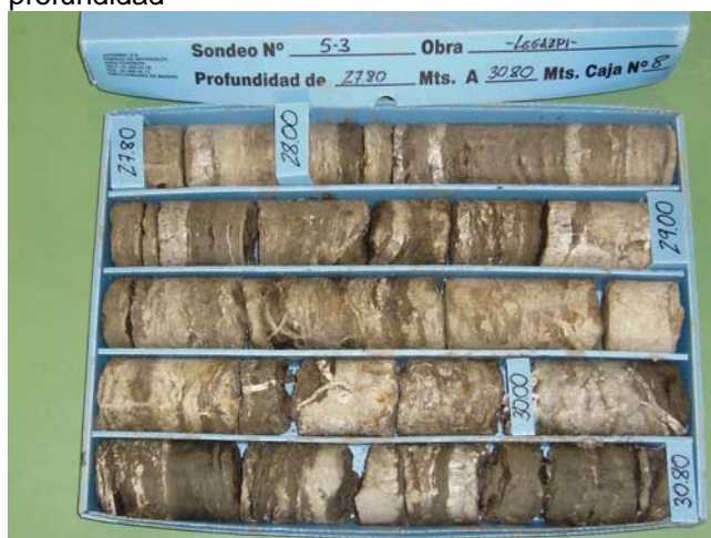
Sondeo S-3, C-8, de 27,80 m a 30,80 m de profundidad
