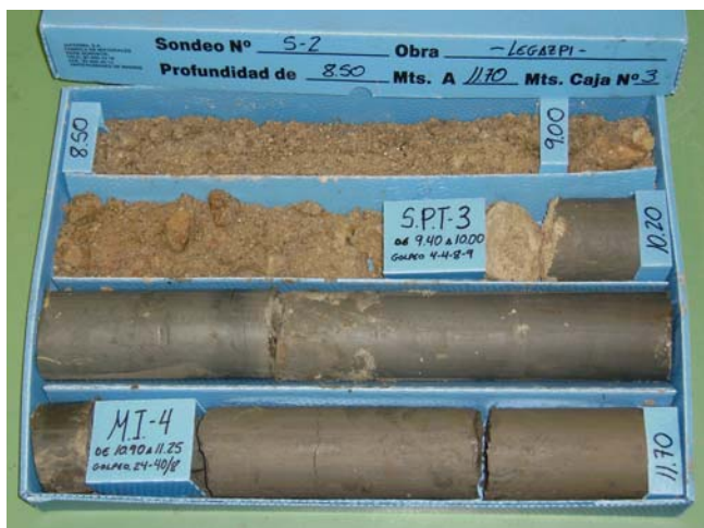
Sondeo S-2, C-3, de 8,50 m a 11,70 m de profundidad
