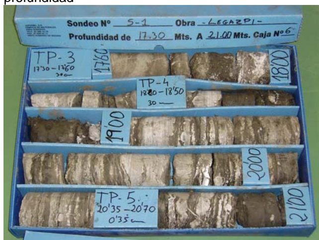
Sondeo S-1, C-6, de 17,30 m a 21,00 m de profundidad
