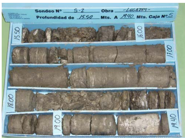
Sondeo S-2, C-5, de 15,50 m a 19,40 m de profundidad
