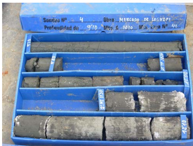
Sondeo S-4, C-4, de 9,10 m a 12,10 m de profundidad
