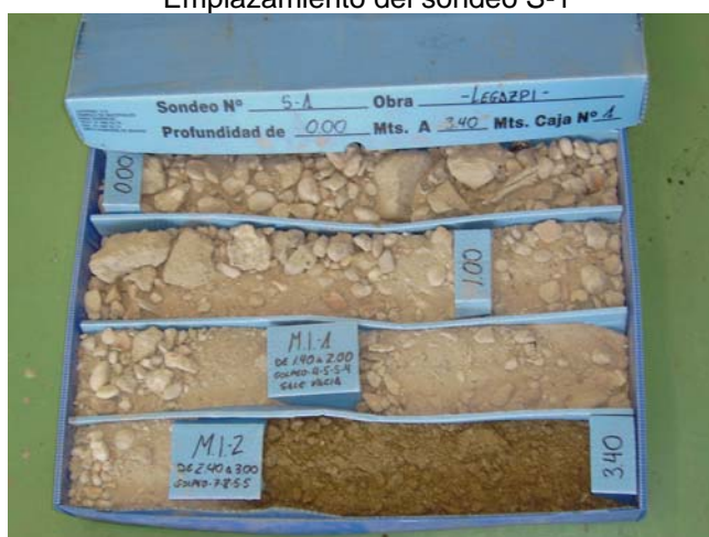
Sondeo S-1, C-1, 0,00 m a 3,40 m de profundidad
