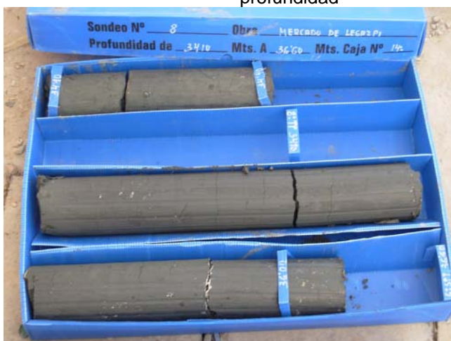
Sondeo S-8, C-14, de 34,10 m a 36,60 m de profundidad
